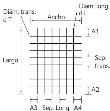
Línea Mini. Paneles de 2m x 3m (sup. 6m<sup>2</sup>)
