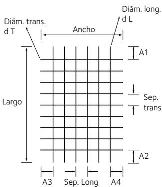
Salientes A1, A2, A3, A4: se definirán en función de las dimensiones del panel, diámetros y separaciones entre barras.
